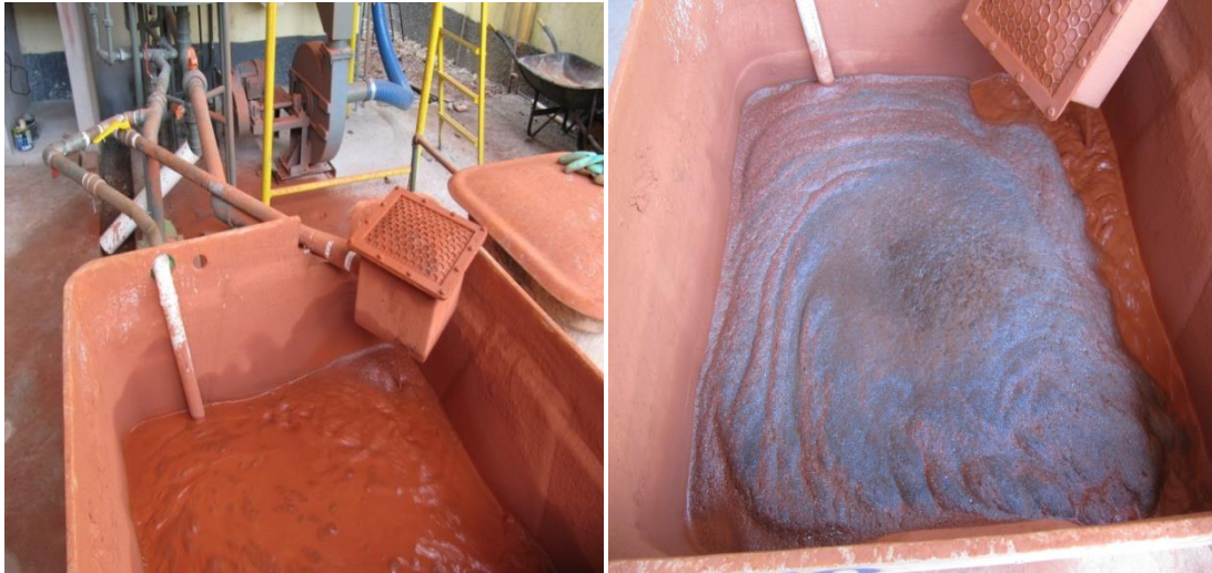
Figura 3.20 – Vistas da caixa de preparação da suspensão de resíduo.
