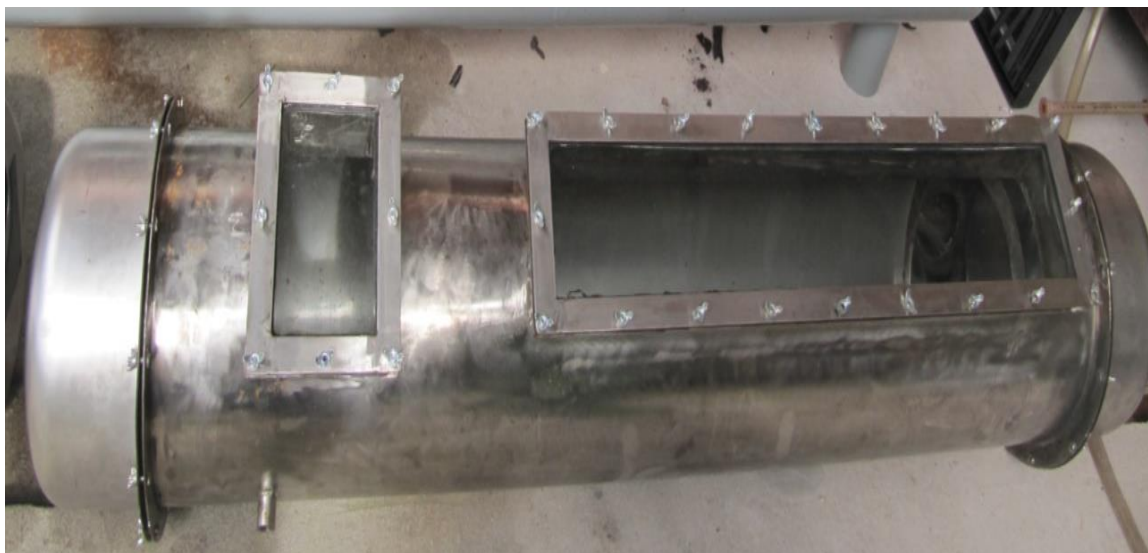
Figura 3.17 – Torre de recheio que durante o processo de fabricação e montagem.
