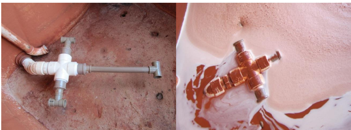
Figura 3.25 – Captador de sucção com baixa turbulência utilizado no experimento com sobrenadante de RB. A esquerda vemos o captador montado e a direita em operação.
