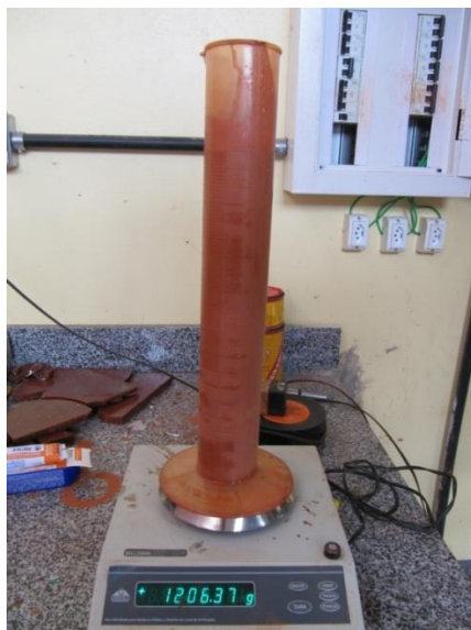
Figura 3.33 – Balança e proveta utilizadas pra controlar o teor de sólidos na suspensão de RB.
