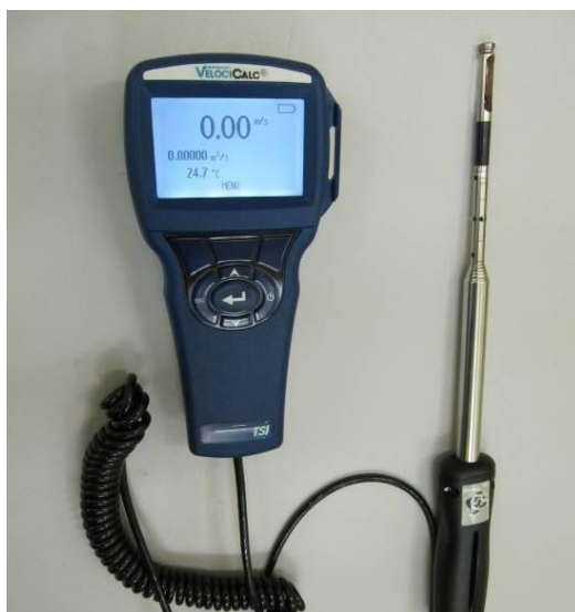
Figura 3.29 – Anemômetro e sonda de medição.
