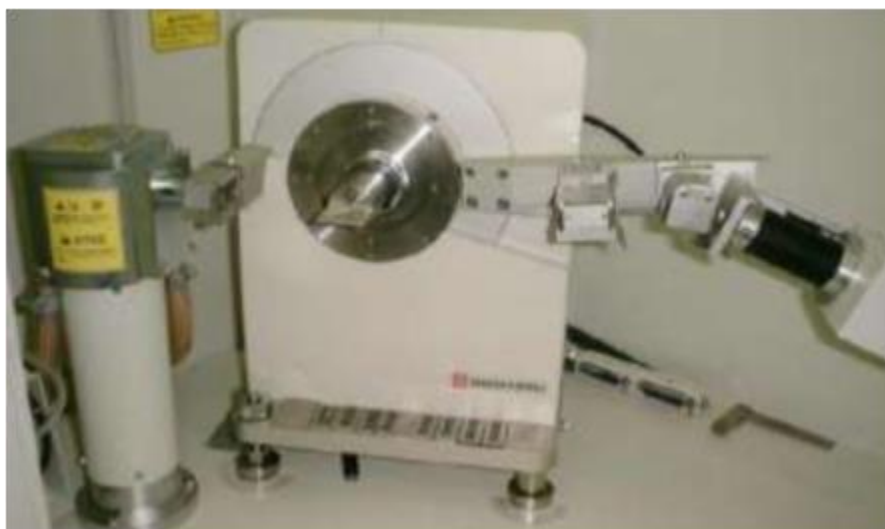
Figura 3.34 – Difratorômetro Philips (PW 3710) do Centro de Geociências da UFPA
