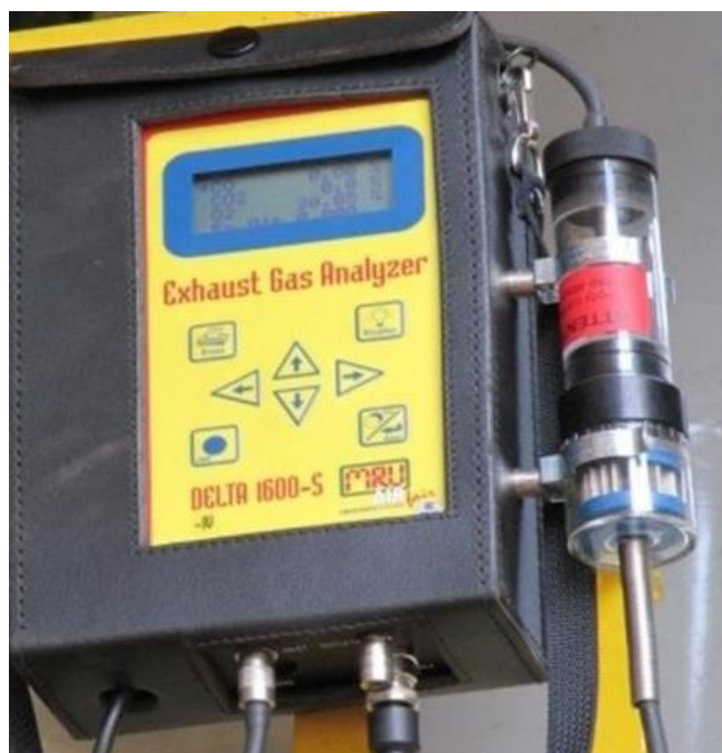
Figura 3.28 – Analisador de gases por infravermelho não dispersivo MRU Delta.
