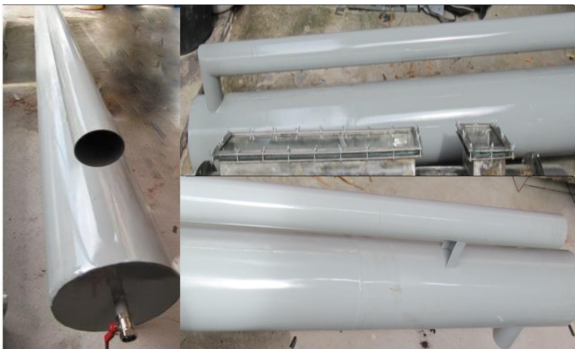
Figura 3.9 – Detalhes do trocador de calor tubular na fabricação e montagem.
