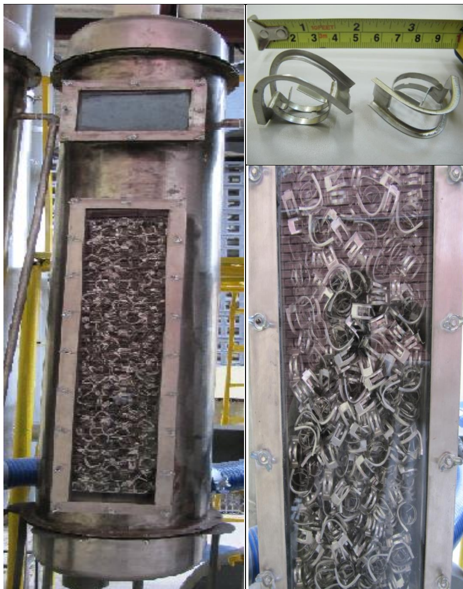
Figuras 3.18 – Torre de recheio preenchida com selas distribuídas randomicamente, no detalhe as selas em aço inoxidável.
