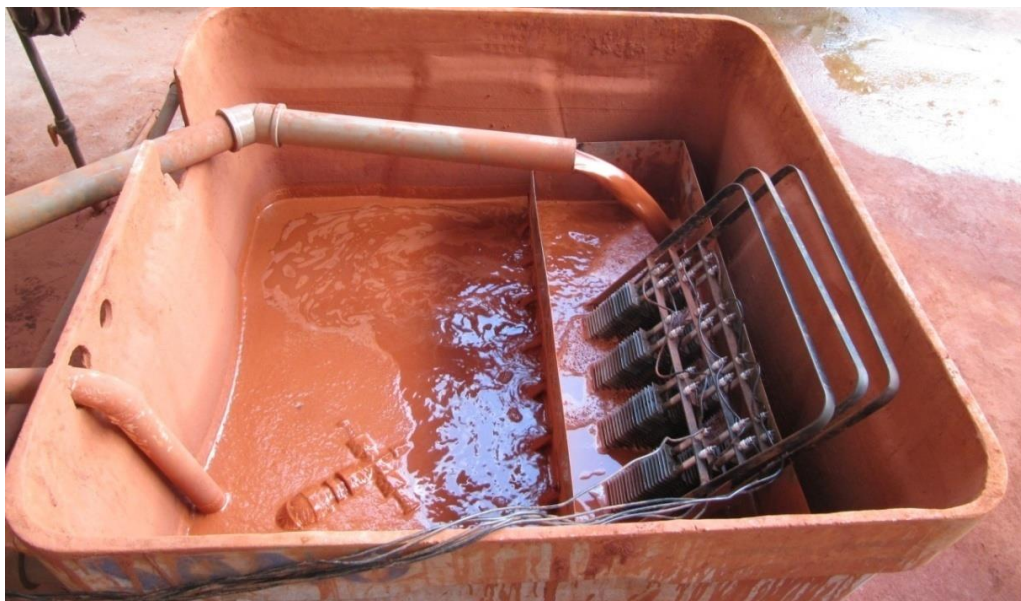
Figura 3.24 – Vista do experimento com sobrenadante aquecido. À direita temos a caixa de retorno com dez saídas ajustáveis e o conjunto de resistências para aquecimento.
