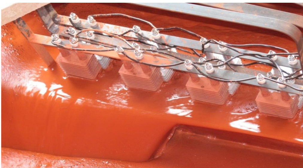
Figura 3.23 – Conjuntos de resistências utilizados para aquecer a suspensão de RB.
