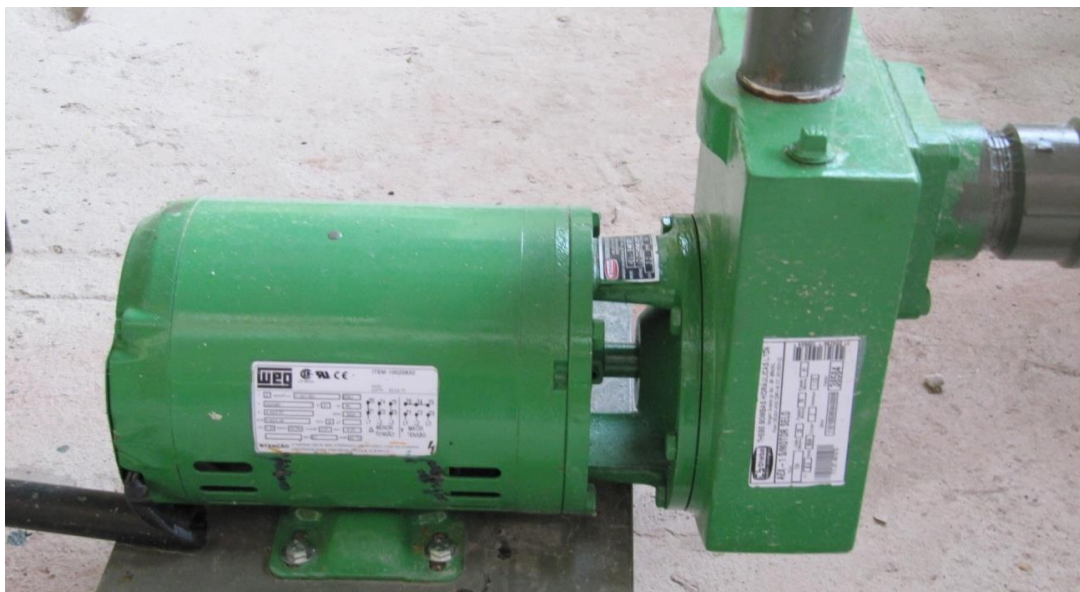
Figura 3.22 – Bomba centrífuga autoeskorvante adequada para recalque de lama.
