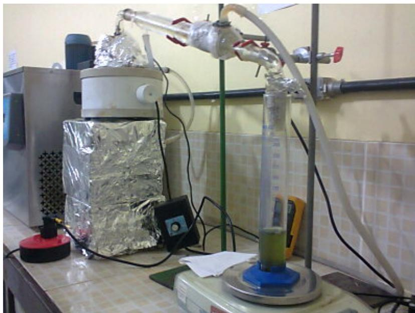
**Figura 4. 20.** Sistema utilizado no processo de construção das curvas de destilação.
