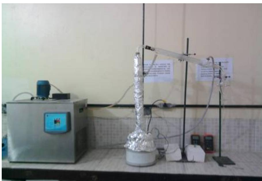
**Figura 4. 19.** Sistema utilizado no processo de redestilação.
