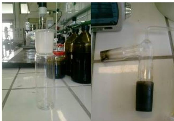
**Figura 4. 6.** Aparato experimental: (a) Reator de vidro borosilicato; (b) Cabeça móvel do reator.
