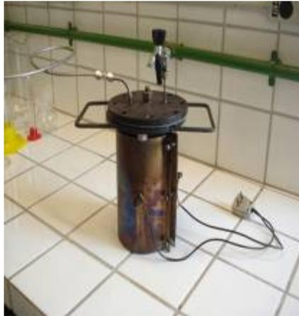
**Figura 4. 8.** Reator craqueador de aço inox.
