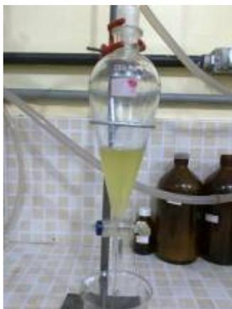
**Figura 5. 16** Coleta da fração de gasolina, após processo de destilação.
