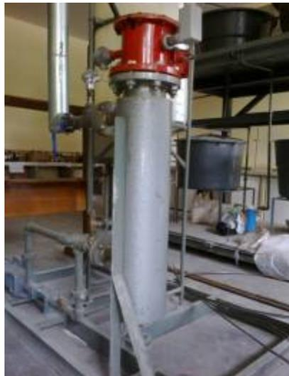
**Figura 3. 4.** Pré-aquecedor do Processo de Craqueamento.
