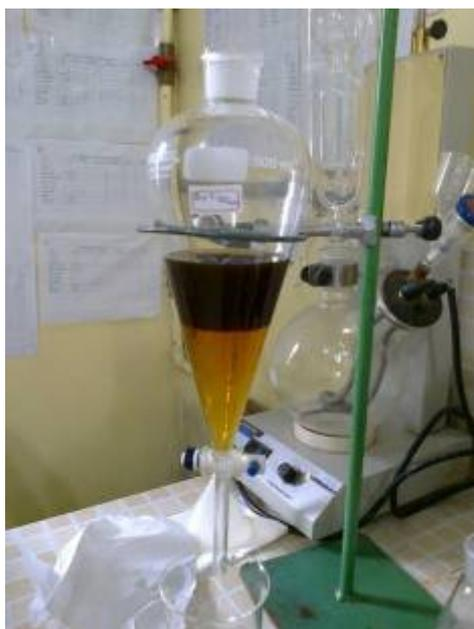
**Figura 4. 18.** Processo de extração líquido-líquido.
