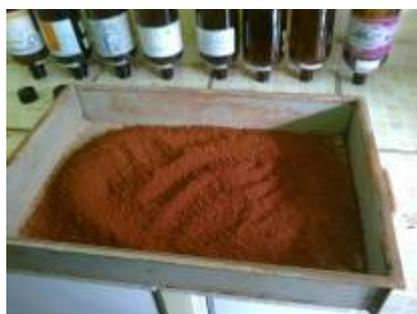
**Figura 5. 14** Lama Vermelha após cominuição<sup>a</sup>/Lama Vermelha após tratamento térmico<sup>b</sup>.
