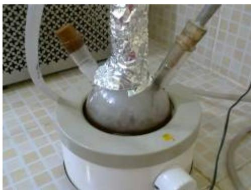
**Figura 5. 15** - Processo de aquecimento na unidade de destilação.
