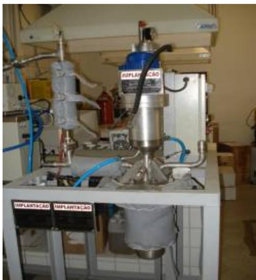
**Figura 5. 4:**Unidade de Craqueamento (Semi-Piloto).
