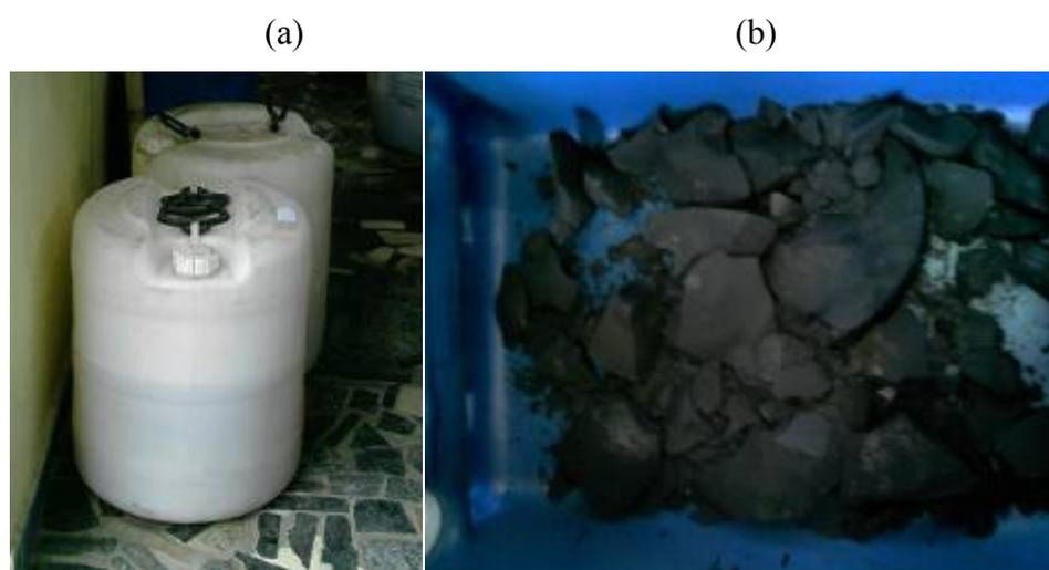
**Figura 4. 14.** (a) PLO produzido na unidade piloto de craqueamento / (b) Resíduo do craqueamento da unidade piloto.
