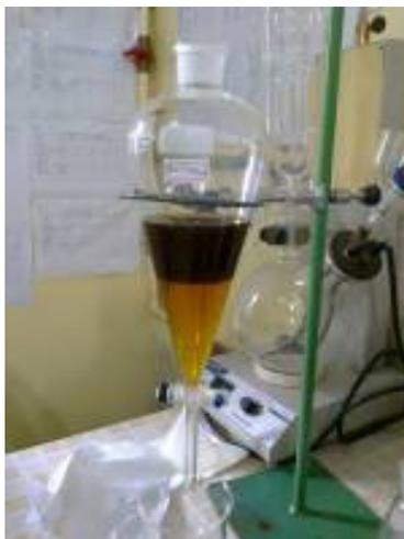
**Figura 5. 25** Processo de Extração Líquido-líquido.
