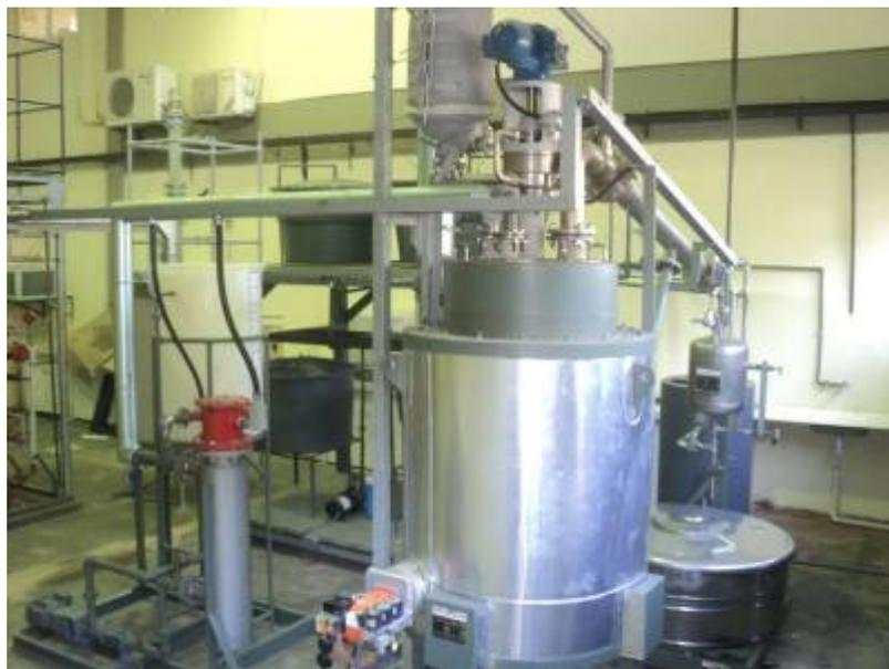
**Figura 3. 1.** Unidade de Craqueamento (THERMTEK/LEQ/ITEC/IME/UFPA).
