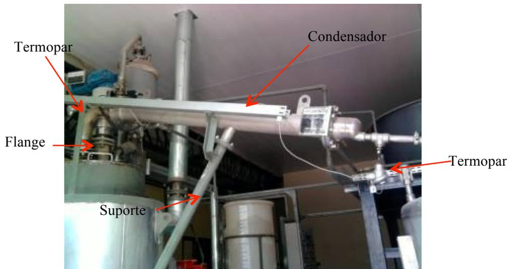
**Figura 3. 10.** Condensador da unidade de craqueamento piloto C01.
