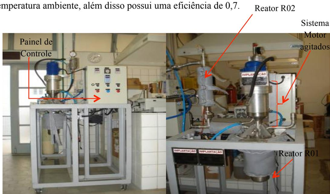
(a) Sistema de controle / (b) Unidade semi-piloto de craqueamento.
