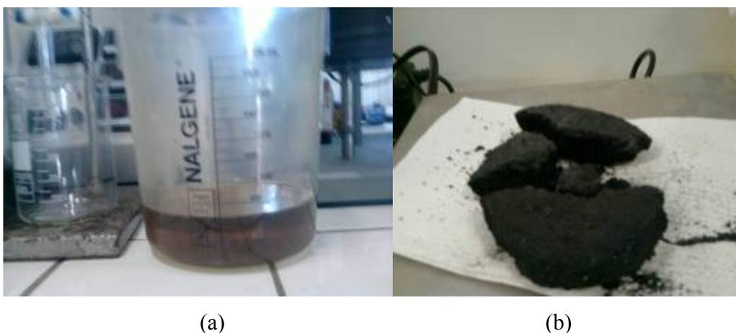
**Figura 5. 6:** (a) PLO obtido após processo de craqueamento/(b) Resíduo do craqueamento.
