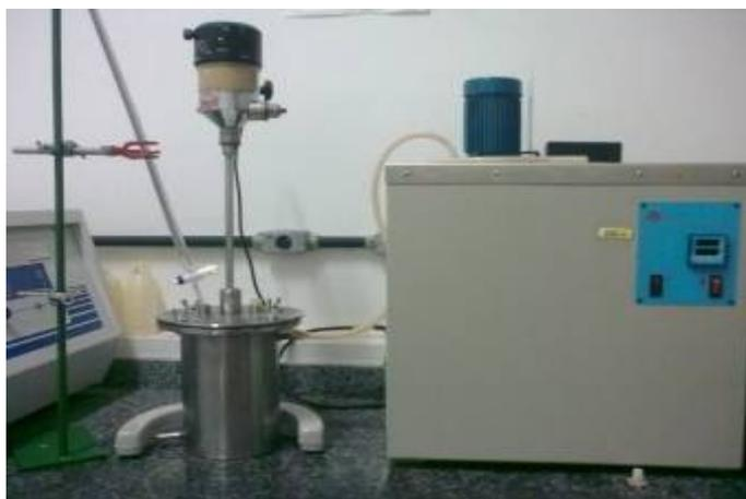
**Figura 5. 1:** Reator de aço utilizado na etapa de neutralização.
