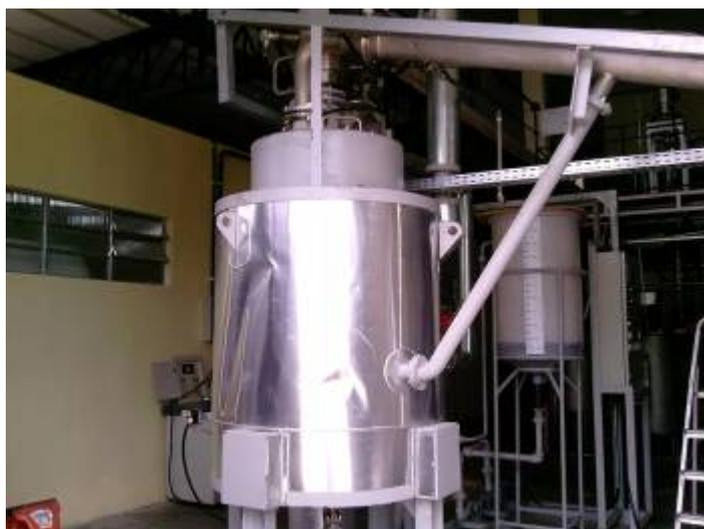
**Figura 3. 7.** Reator de Leito Agitado da Unidade Piloto de Craqueamento (R01).
