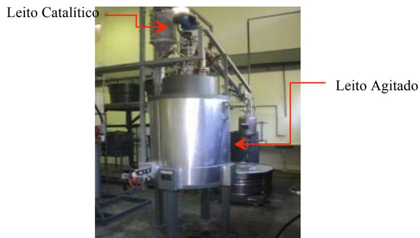
**Figura 3. 6.** Unidade Piloto de Craqueamento/THERMTEK/LEQ/ITEC/IME/UFPA.
