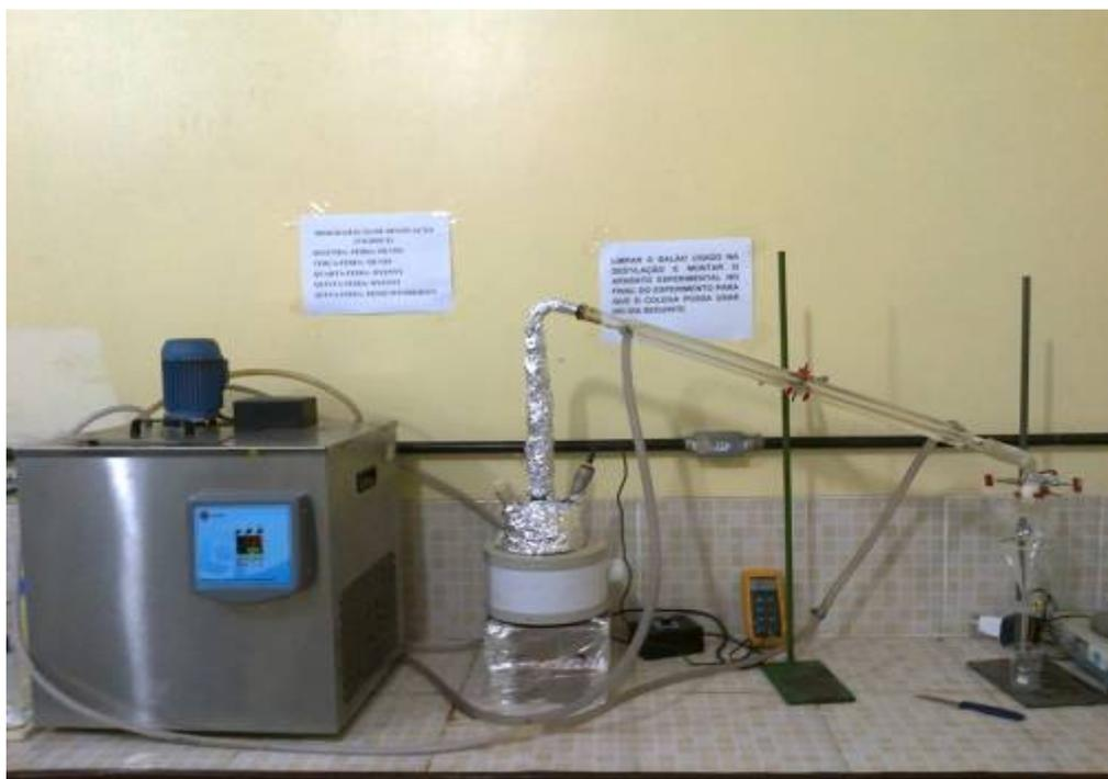
**Figura 4. 16.** Sistema de destilação fracionada com isolamento térmico.
