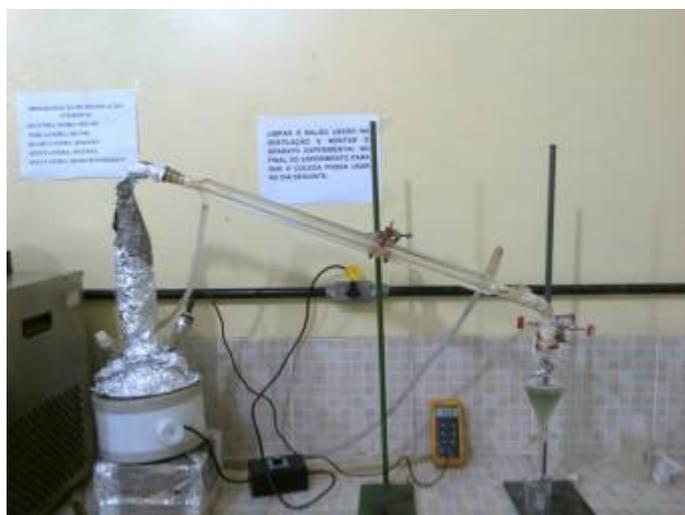
**Figura 5. 17** Sistema de destilação fracionada.
