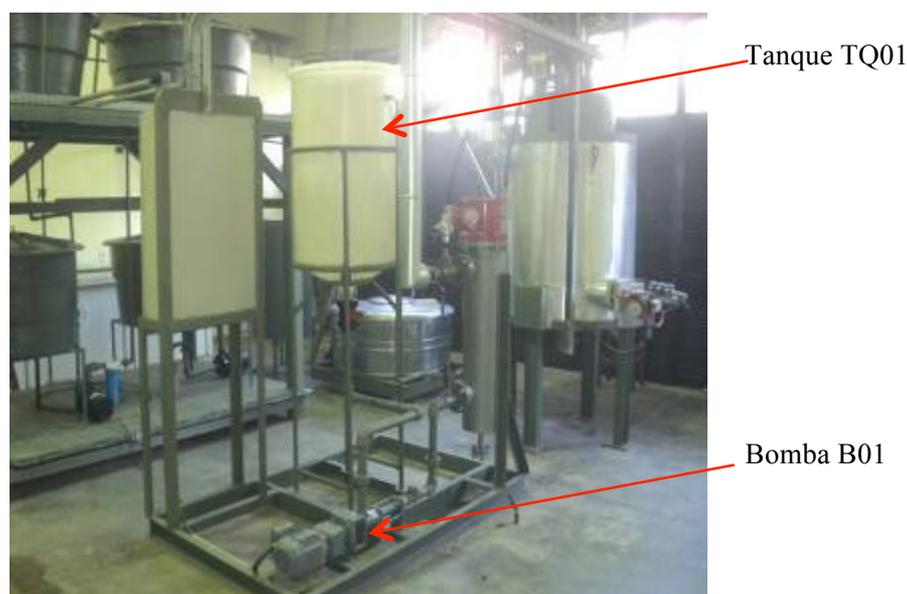
**Figura 3. 3.** Sistema de alimentação (Tanque TQ01 e Bomba dosadora B01).
