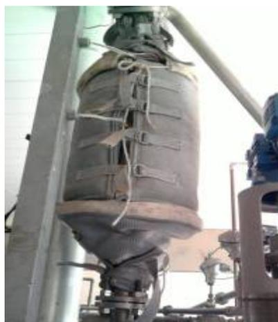
**Figura 3. 8.** Reator catalítico da Unidade Piloto de Craqueamento (R02).
