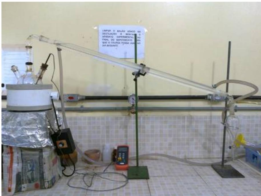
**Figura 4. 15.** Sistema de destilação Simples.
