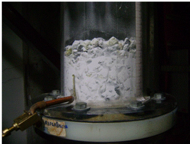
Figura 4.26 - Fluidização das partículas de alumina percolando por entre o leito poroso de crosta (10% Alumina + Crosta – 8 mm, U_g = 0,14 m/s).
