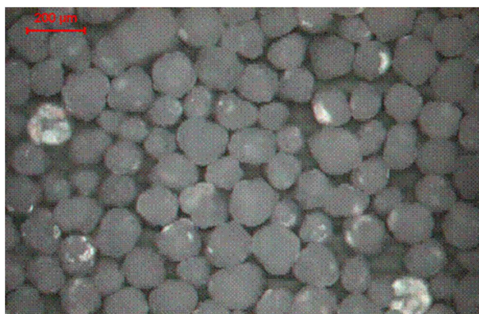
Figura 3.1 – Imagem da Alumina obtida pelo IMAGE J para determinação da esfericidade (Fonte: LTP – UFPA).
