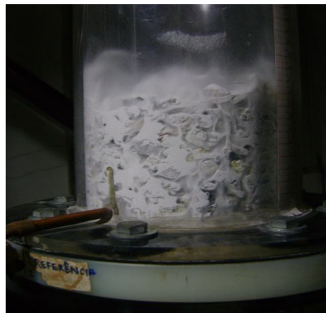
Figura 4.28 - Fluidização das partículas de alumina percolando por entre o leito poroso de crosta (10% Alumina + Crosta – 10 mm, U_g = 0,4 m/s)
