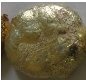
Figura 4.8 – Lingote Au-Cu-Ag no estado bruto de fusão.
