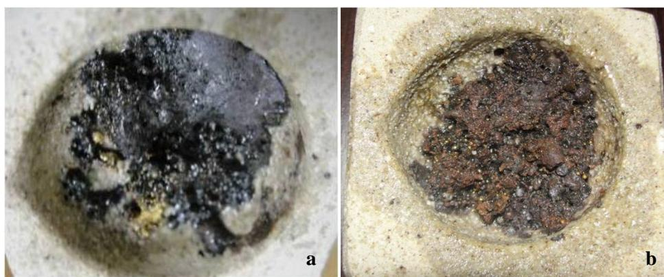
Figura 4.3 – Matéria prima submetida à temperatura de  $1065^{\circ}C$  (a), por 20 minutos, e de  $1071^{\circ}C$  (b), por 30 minutos..
