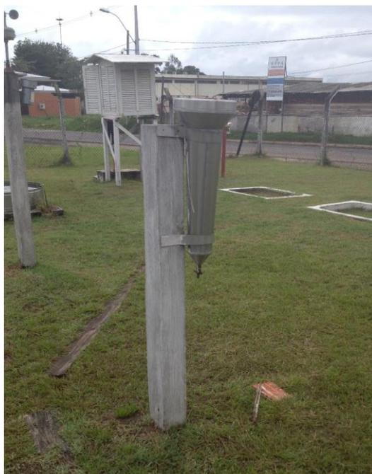
**Figura 2.5 – Pluviômetro tipo *Ville de Paris* localizado no Campus I da UFPA**
