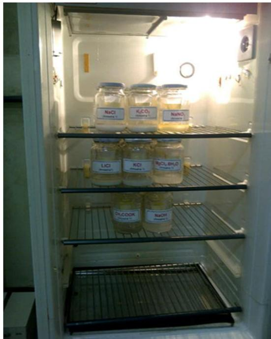
**Figura 4.34** – Amostras colocadas em câmara de climatização estufa BOD
