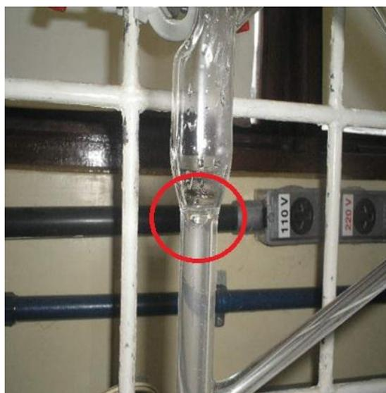
**Figura 4.22** – Detalhe do óleo (círculo vermelho) durante a extração antes de precipitar (Foto: Eduardo Mafra)
