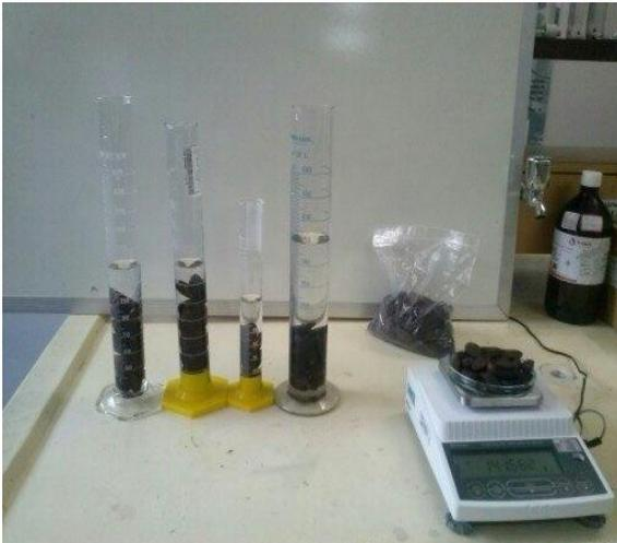
**Figura 4.8** – Aparato usado para determinar a densidade das sementes de puxuri pelo método do deslocamento de líquidos (Foto Eduardo Mafra)
