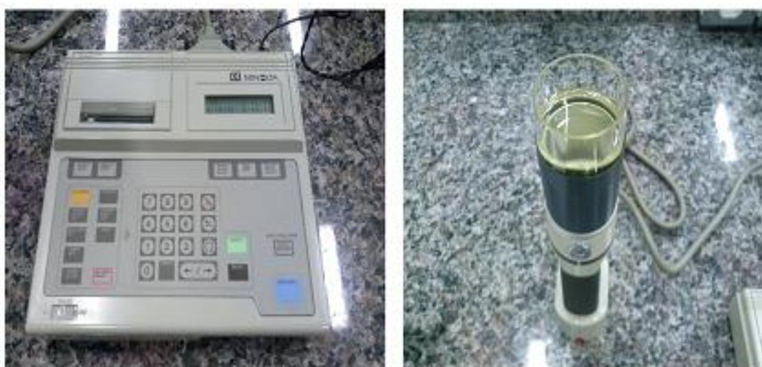
**Figura 4.30** – Instrumento usado na análise colorimétrica do óleo essencial de puxuri (Foto: Eduardo Mafra)
