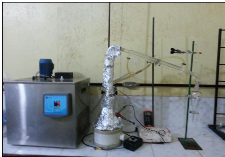
Figura 38 - Unidade de destilação em escala de bancada
