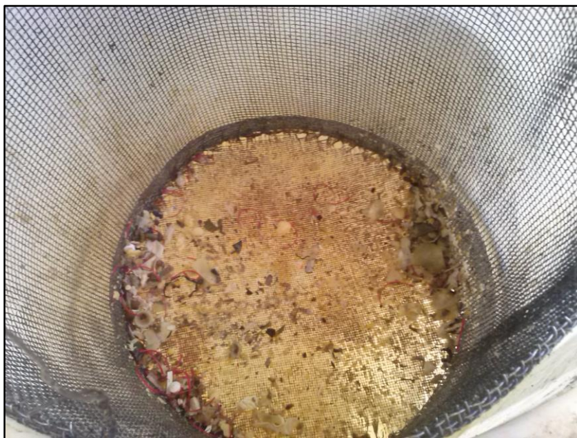
Figura 25 - Peneiramento e retenção de resíduos dentro do tanque de PEAD
