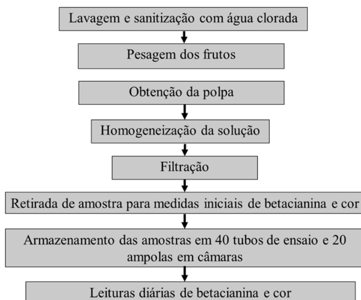
Figura 15 - Fluxograma com as etapas de pré-processamento e extração do corante de pitaya
