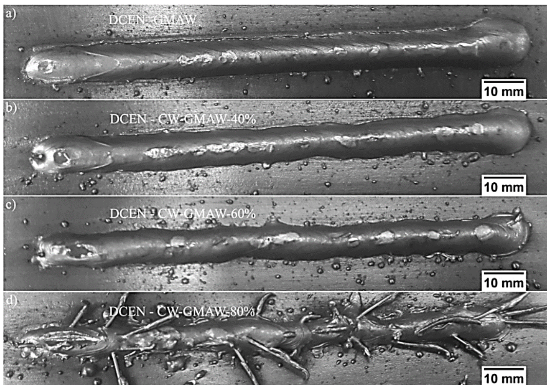
Figura 3.14 Aspectos do cordão para polaridade negativa. (a) GMAW convencional. (b) CW-GMAW-40%. (c) CWGMAW-60%. (d) CW-GNAW80%
