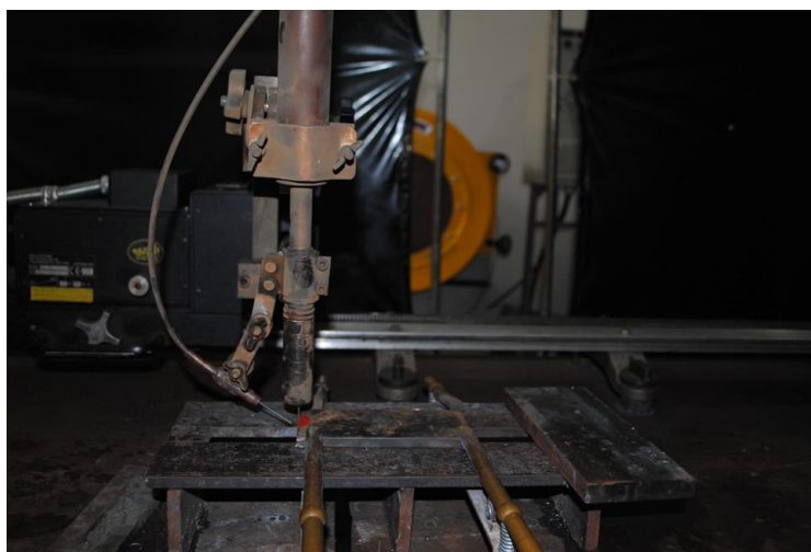
Figura 3.4 – Bancada preparada para execução da soldagem GMAW-CW .
