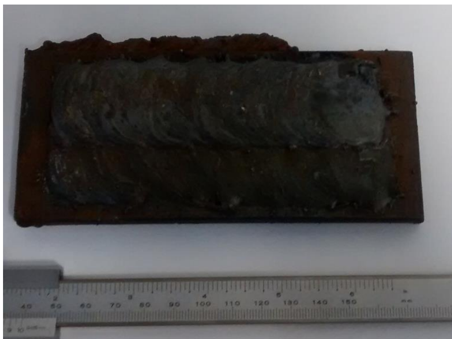
Figura 4.20 – Superfície da placa de RCC apresentando porosidades e a canaleta ao sobreposição entre os cordões de solda.
