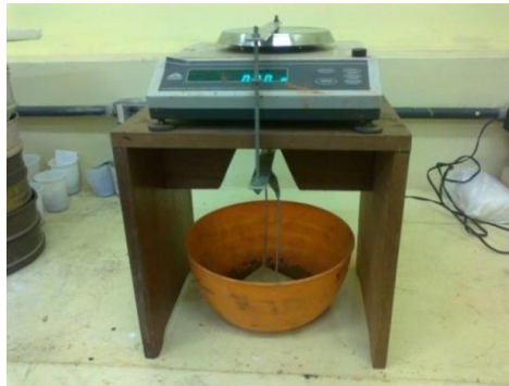
Figura 3.15 - Aparato para obter a massa imersa
