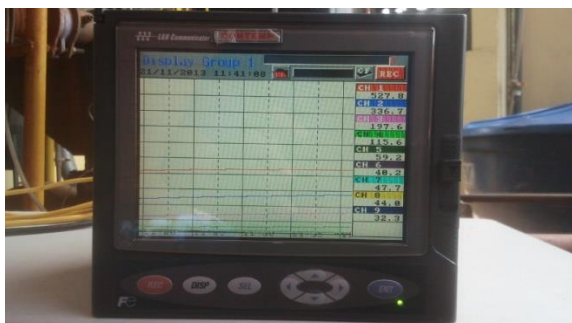
Figura 3.10 – Paperless Recorder do tipo PHL
