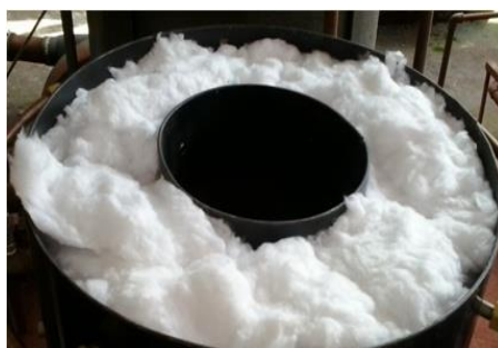
Figura 3.8 – Lã de rocha contida no reator
