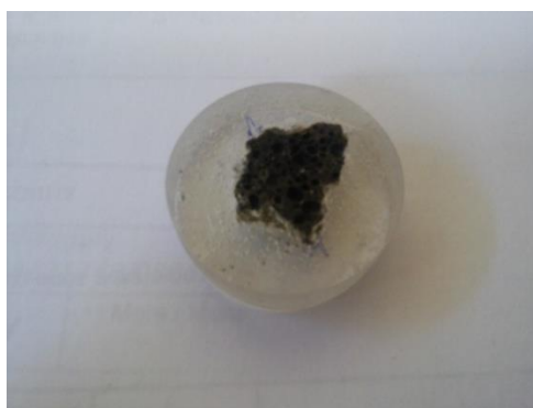
Figura 3.14 – Embutimento do agregado sintético
