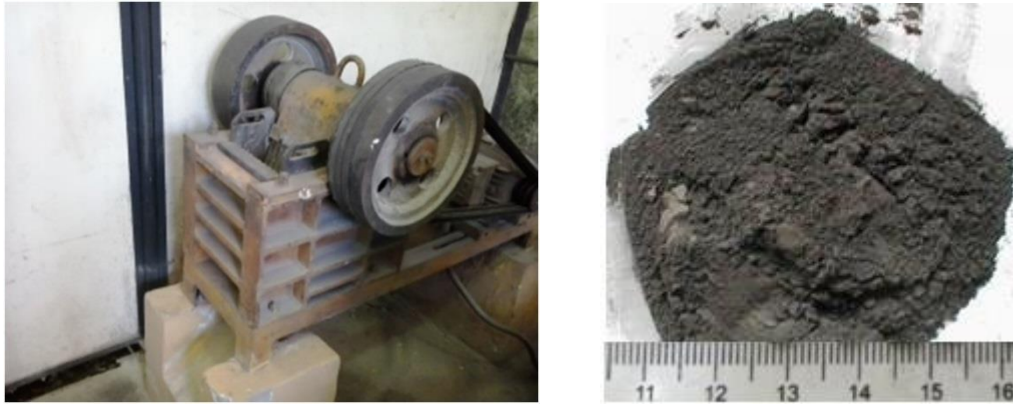
(a) Britador de mandíbulas, (b) Carvão pulverizado Figura 3.3 – (a) Britador de mandíbulas, (b) Carvão pulverizado
